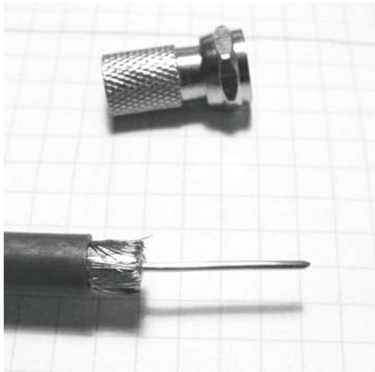
1. Koaxialkabel abisolieren:
