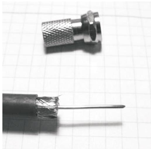
1. Koaxialkabel abisolieren:
