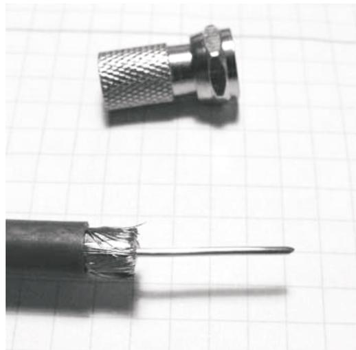
1. Koaxialkabel abisolieren:
