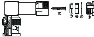
Step 2 STRIP THE CABLE INNER CONDUTOR, DIELECTRIC, BRAID,
