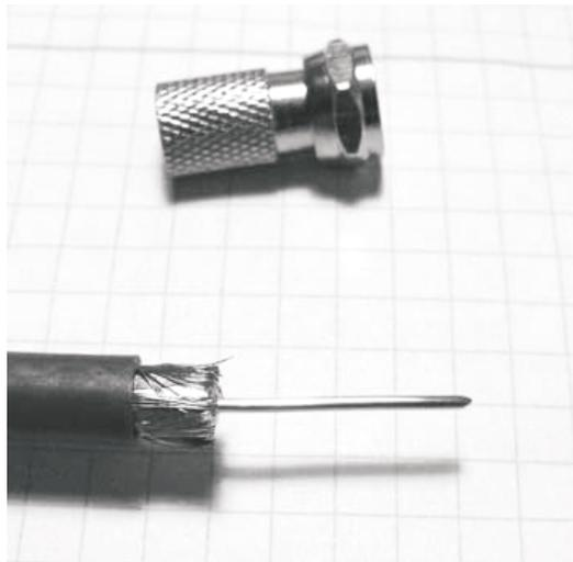
1. Koaxialkabel abisolieren:
