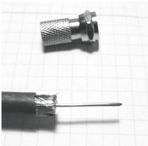
1. Koaxialkabel abisolieren:
