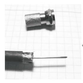
1. Koaxialkabel abisolieren: ca. 15 mm vom Mittelleiter und 7 mm vom Mantel.
