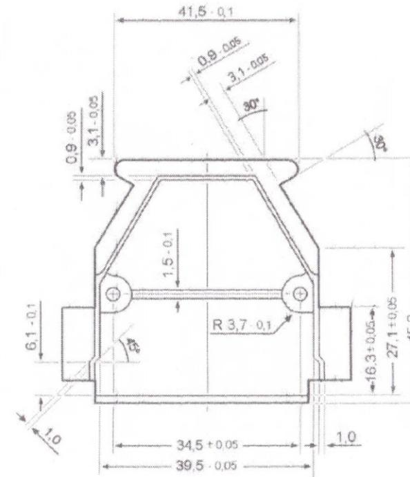
Außenkontur und Lochabstände mit Gehäusedeckel abgestimmt
