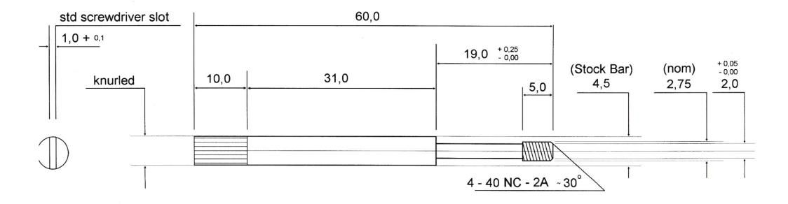
Bezeichnung: Rändelschraube für Schraubverriegelungsgehäuse
