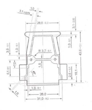
Außenkontur und Lochabstände mit Gehäusedeckel abgestimmt unbemaßte Radien R=1,0 gratfrei
