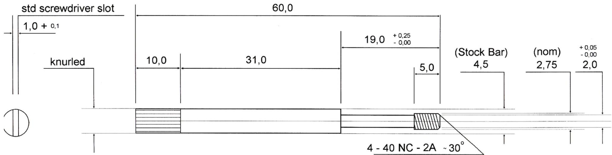
Bezeichnung: Rändelschraube für Schraubverriegelungsgehäuse
