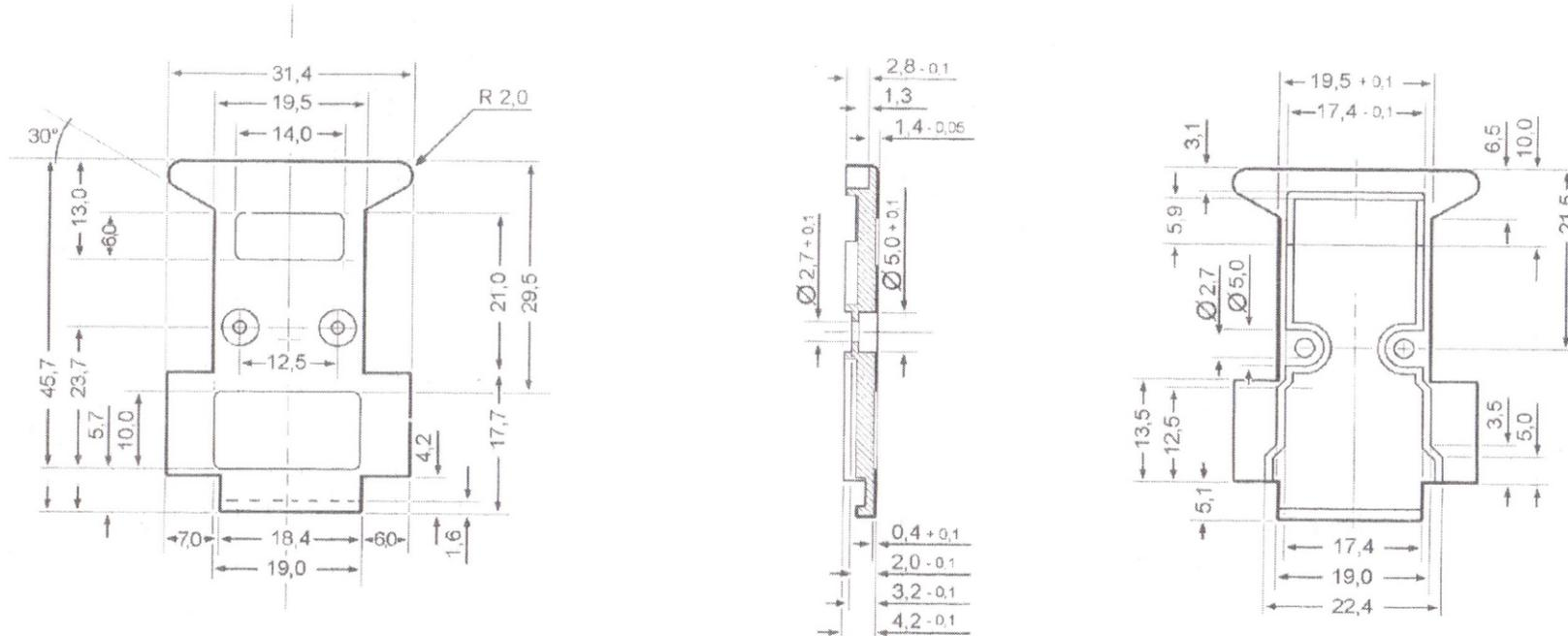
Bezeichnung: 9-polig, Deckel, Ausgang gerade
